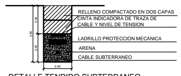
DETALLE TENDIDO SUBTERRANEO
